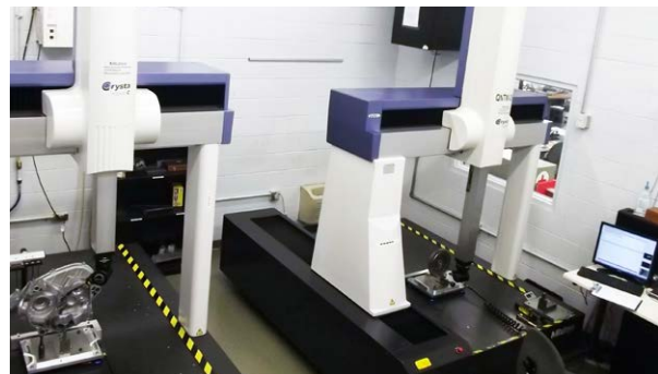
REVO-equipped CMMs at Kawasaki’s, Maryville
